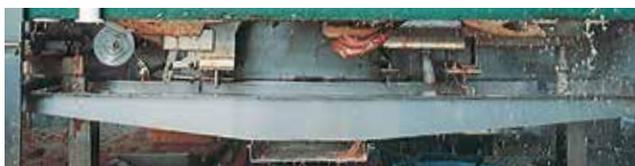
魚体は丸刃、スクレパーを通過し裁割から魚卵・内臓の取り出しまでを瞬時にこなします。さらに、一連の工程のなかで、スクレパーの上部の凸起がメフンをかき取り、ブラシ・水噴射によりメフンを洗浄します。
