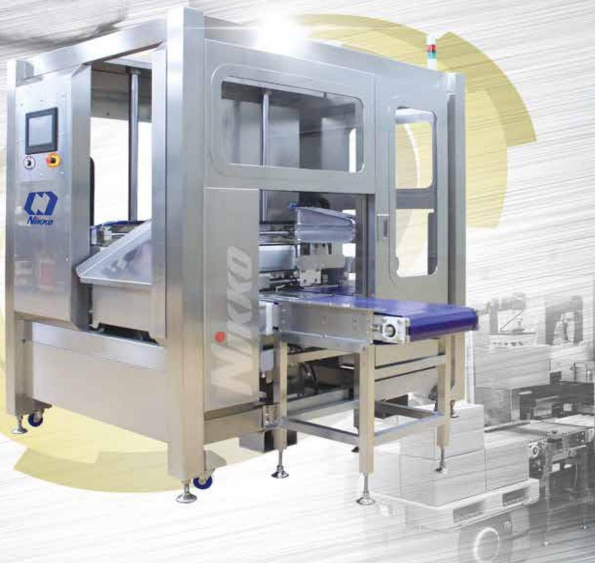
原料段ボールケースの開梱と原料の取り出しを自動化
