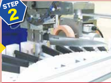
ロボットが自動的に研磨作業開始
